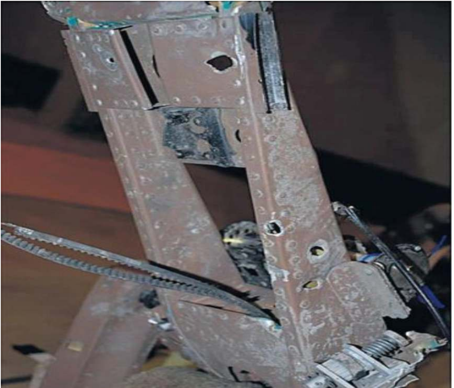
بک میزائل ٹکڑے ہونے سے متصادم نقصان کے نمونے
